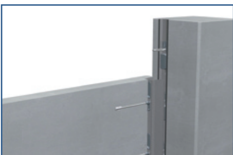
Bild 1: Vergusskanal mit Seilschleifen
