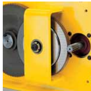
Getriebe mit Rutschkupplung (1.000 kg Tragfähigkeit)
