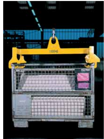
Beim Einsatz der Gitterboxtraverse müssen die Traversenhaken immer am oberen Rahmen der Gitterboxen eingehängt werden.
