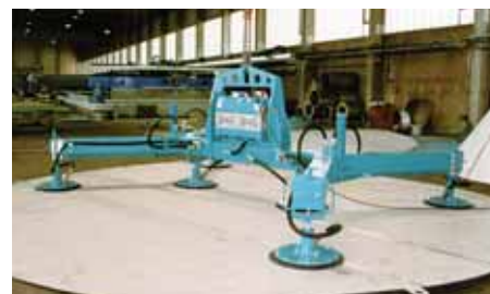
Kappa-Levator mit Elektromotor, ausgerüstet mit Traverse und drei Saugplatten.
