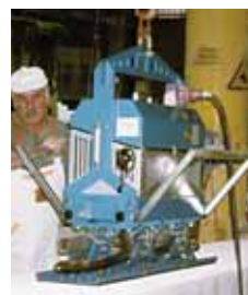
Kappa-Levator mit Elektromotor, ausgerüstet mit Traverse und drei Saugplatten.
