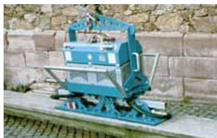
Kappa-Levator mit Verbrennungsmotor, mit Traverse und drei Saugplatten.
