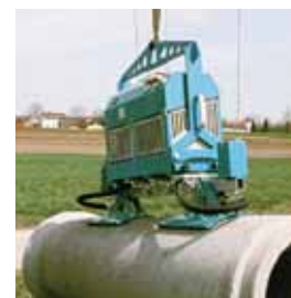
Kappa-Levator mit Verbrennungsmotor, mit Traverse und zwei Sonder-Saugplatten.
