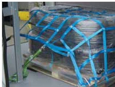
Netz im Direktzurrverfahren
