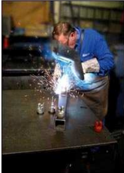
Powerpoint-Anschlagöse in 2-3 Min. sicher angebracht.
