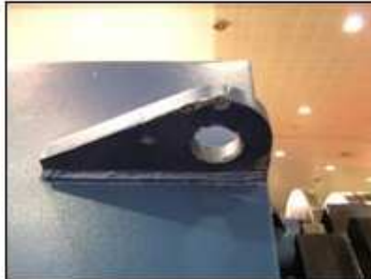
Schon beim Aufstellen der neuen Maschine ist die Aufhängung zerstört.
