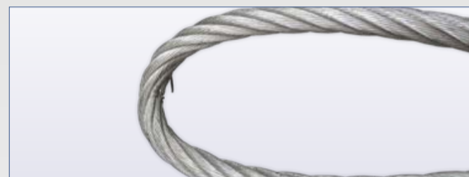
Quetschungen im Auflagebereich
