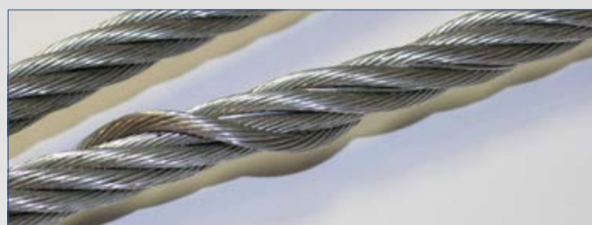
Lockerung der Außenlage
