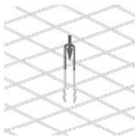
Bild 19: Verbundnadel spätestens 60 min. nach Zugabe des Anmachwassers durch die Dämmstoffplatte in den Frischbeton bis zum Schalungsboden drücken. Danach die Verbundnadel bis zum Erreichen der erforderlichen Einbindetiefe wieder herausziehen. Ein Eintragen der Wärmedämmung in den Verankerungsgrund ist zu verhindern.
