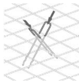
Bild 20: Verbundnadeln spätestens 60 min. nach Zugabe des Anmachwassers nacheinander unter 45° durch die Dämmstoffplatte in den Frischbeton bis zum Schalungsboden drücken. Der Kreuzungspunkt der beiden Nadeln soll in der Mitte der Wärmedämmung liegen. Danach die Verbundnadeln bis zum Erreichen der erforderlichen Einbindetiefe wieder herausziehen.
