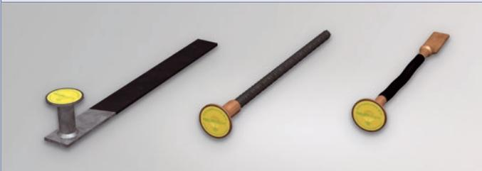
Als Erdungsbuchsen werden Produkte bezeichnet, die innerhalb eines Betonbauteils verbaut werden. Diese können zur Herstellung eines Anschlusspunktes für außen liegende Leiter verwendet werden. Ebenfalls sind rein innenliegende Verbindungen sowie komplett durchführende Leitungen mit zwei Anschlussbuchsen möglich.
