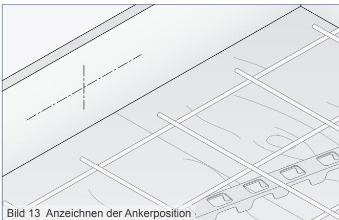
Bild 13 Anzeichnen der Ankerposition
