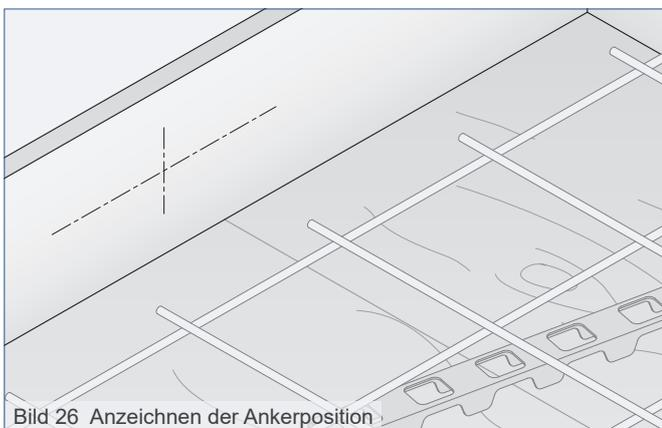
Bild 26 Anzeichnen der Ankerposition
