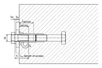
1)  $t_w + t_{fix} + L_{sd,min} \le L_s \le t_w + t_{fix} + L_{sd,max}$
