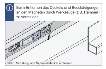
Nach dem Betonieren können Schalung und Schienendeckel entfernt werden.
