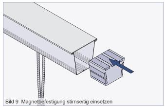
Nun kann die Magnetbefestigung stirnseitig in das Blechprofil der Schiene eingesetzt werden.
