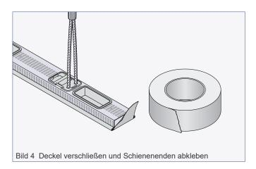
Der Schienendeckel wird nun wieder in seine ursprüngliche Position gebracht und die Schienenenden dicht verschlossen (Klebeband).
