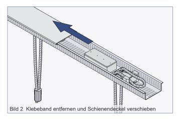
Um die Magnetbefestigungen in die Schiene einsetzen zu können, ist der Verschluss (Klebeband) an den Schienenenden zu entfernen. Im Anschluss wird der Schienendeckel leicht verschoben, um die Magnetbefestigungen in einen
