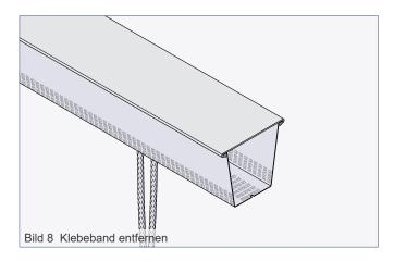
Um die Magnetbefestigungen in die Schiene einsetzen zu können, ist der Verschluss (Klebeband) an den Schienenenden zu entfernen.
