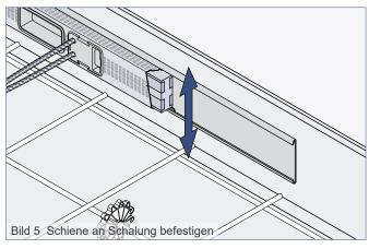
Die Schiene mit den Magnetbefestigungen kann jetzt an der Stahlschalung angebracht werden. Eine Korrektur der Schienenposition ist jederzeit problemlos möglich.
