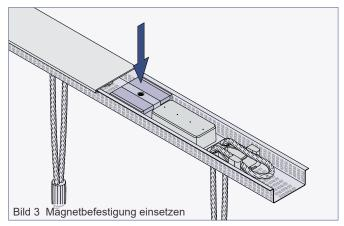
freien Bereich im Blechprofil platzieren zu können. Nun können die Magnetbefestigungen in das Blechprofil der Schiene eingesetzt werden.
