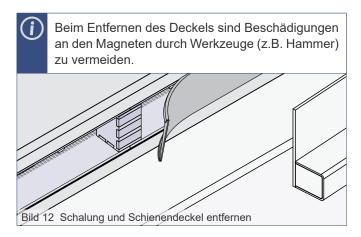
Nach dem Betonieren können Schalung und Schienendeckel entfernt werden.
