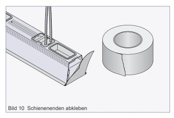
Die Schienenenden werden nun z.B. mit Klebeband dicht wieder verschlossen.
