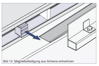
Die Magnetbefestigungen können jetzt einfach und schnell aus der Schiene entfernt und wiederverwendet werden.
