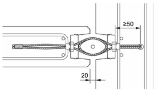
**Bild 14: Anschluss Wand – Wand, T – Anschluss**
