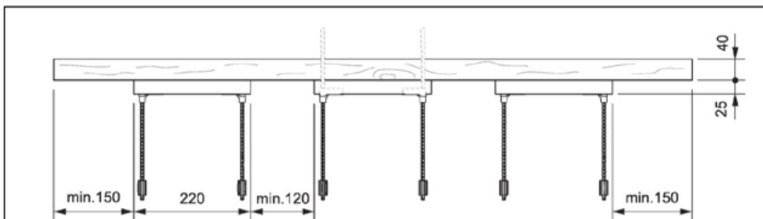
**Bild 3: Power Box mit eingesetzten Seilschlaufen – Längsschnitt**
