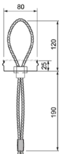
**Bild 4: Power Box mit Seilschlaufe (ausgeklappt) – Querschnitt**
