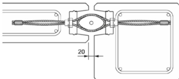
**Bild 16: Anschluss Wand – Stütze**
