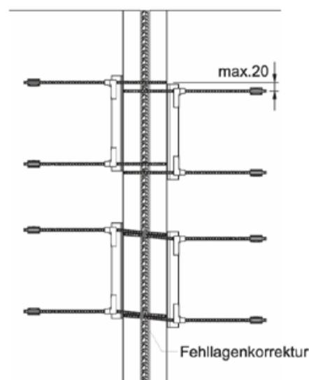
Bild 12: Maximale vertikale Toleranz
