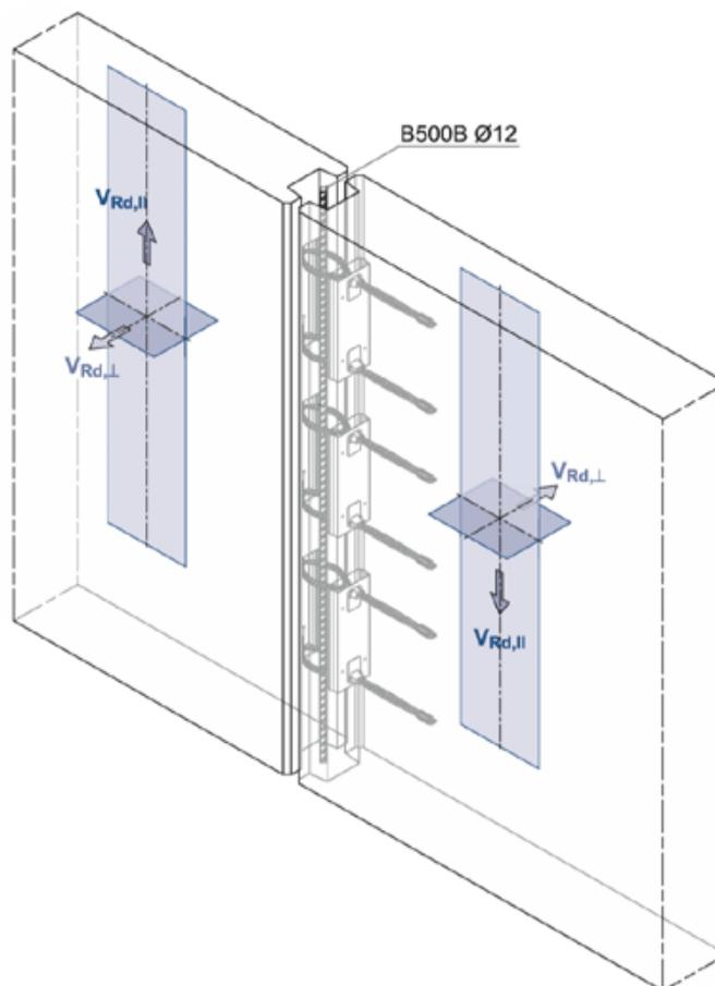
**Bild 2: Einbauzustand ohne Fugenverguss und Darstellung der zulässigen Belastungsrichtung (Querkräfte senkrecht und parallel zur Wandachse)**
