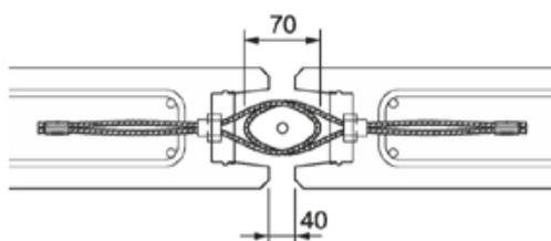
Bild 11: Maximalfuge
