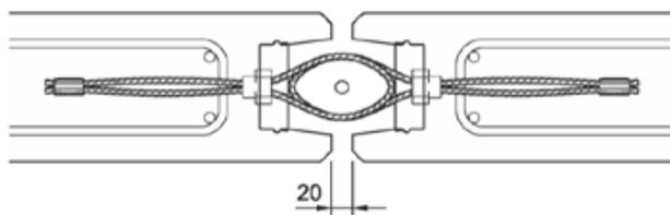
**Bild 13: Anschluss Wand – Wand, Längsanschluss**
