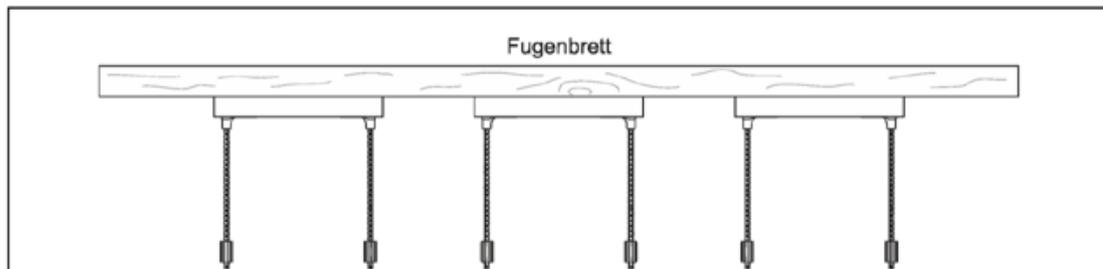
**Bild 1: Auf Fugenbrett fixierte Power Box (Seilschlaufen eingeklappt)**
