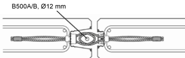
**Bild 14: Anschluss Wand – Wand, Längsanschluss**
