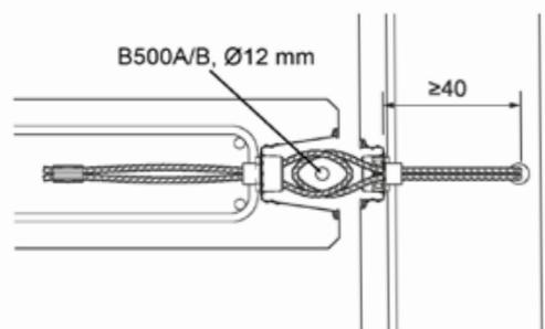
**Bild 15: Anschluss Wand – Wand, Queranschluss**
