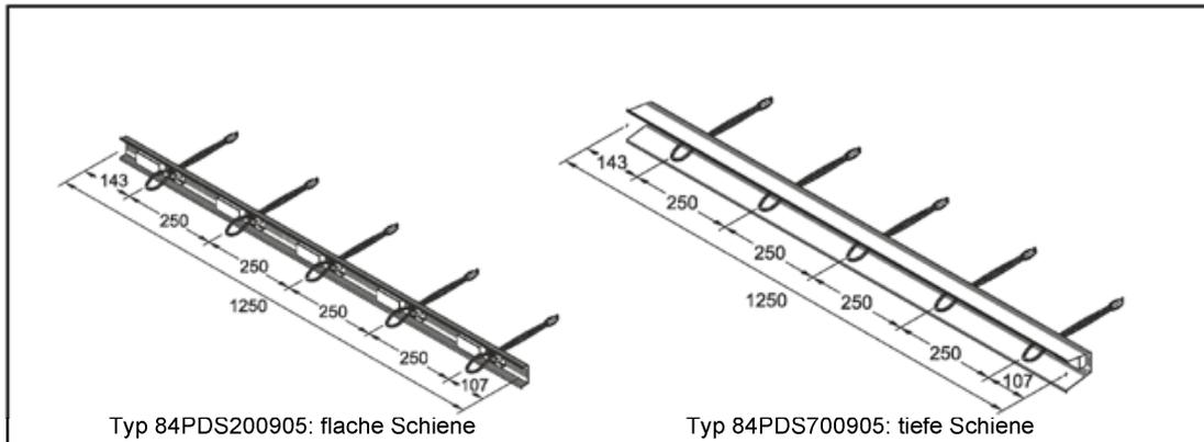
**Bild 3: Verwahrkasten mit eingesetzten Seilschlaufen**
