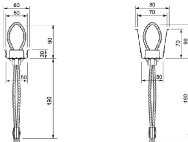
**Bild 4: Verwahrkasten mit Seilschlaufe – Querschnitt**
