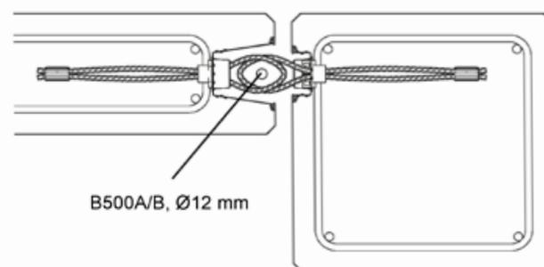
**Bild 16: Anschluss Wand – Stütze**
