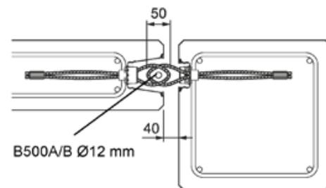
**Bild 13: Maximalfuge (minimal zulässige Überlappung der Seilschlaufen)**
