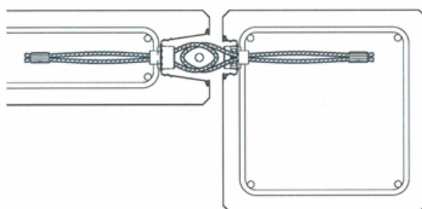
Bild 16: Anschluss Wand – Stütze
