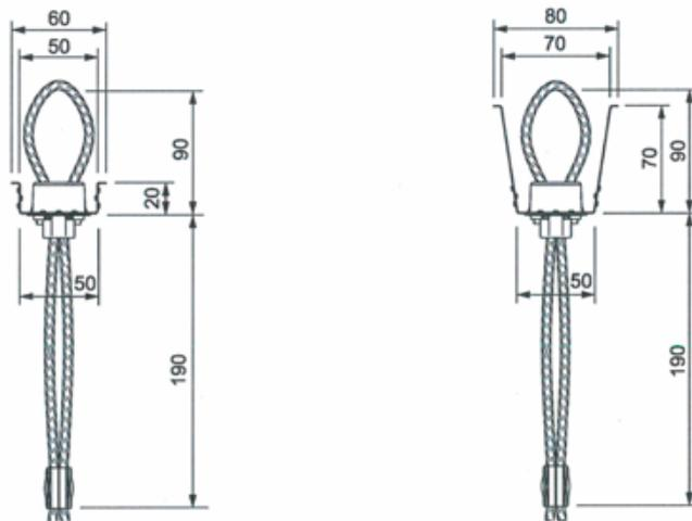
**Bild 4: Verwahrkasten mit Seilschlaufe – Querschnitt**
