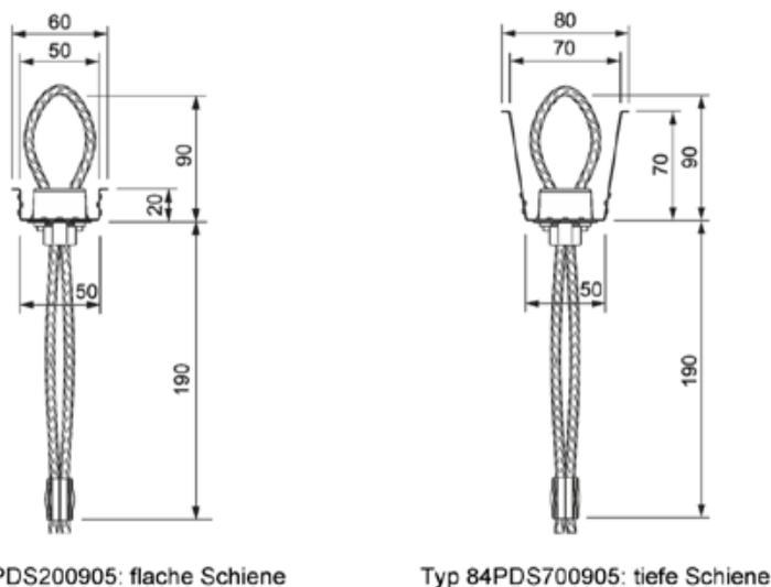
**Bild 4: Verwahrkasten mit Seilschlaufe – Querschnitt**
