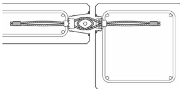
**Bild 16: Anschluss Wand – Stütze**
