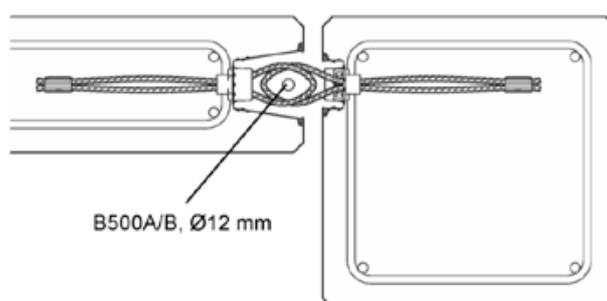
**Bild 16: Anschluss Wand – Stütze**
