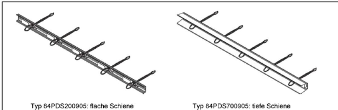
**Bild 1: Verwahrkasten mit eingesetzten Seilschlaufen (im Transportzustand eingeklappt)**
