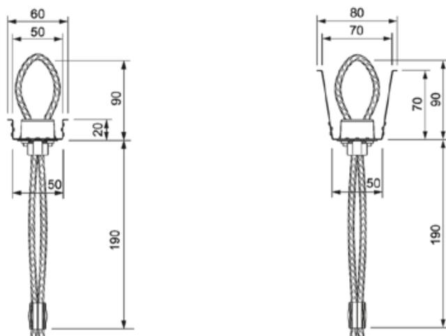
**Bild 4: Verwahrkasten mit Seilschlaufe – Querschnitt**
