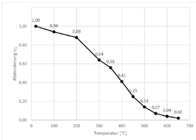
**Diagramm 2: Abminderungsfaktor  $\alpha_{fi}$  in Abhängigkeit der Seiltemperatur**
