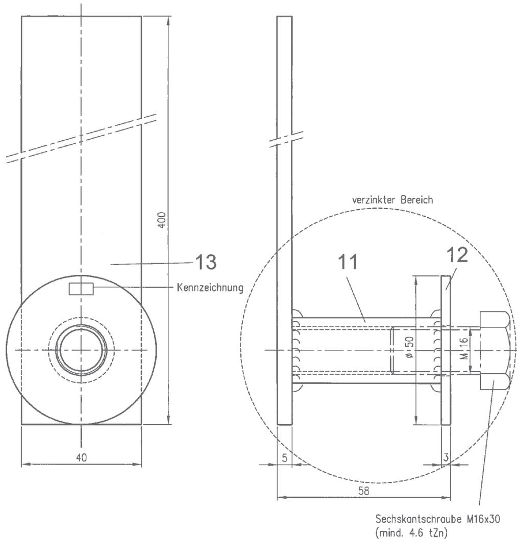
Erdungsanschluss im Bereich der Hülse galvanisch verzinkt
